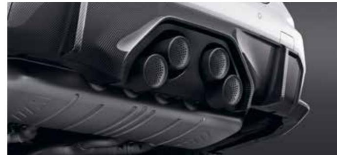
Le système d'échappement M Performance produit une signature sonore de sport automobile sans compromis. Les sorties d'échappement sont entièrement fabriquées en titane.
