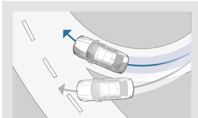
**Le Contrôle de la Transmission** intervient en courbe en transmettant davantage de couple aux roues extérieures au virage pour ralentir les roues intérieures. Résultat : une sécurité et un comportement dynamique améliorés.
